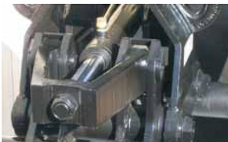
Gros vérin horizontal avec châssis renforcé
