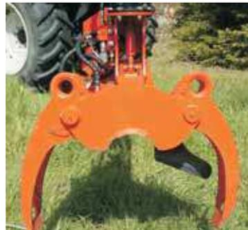
Modèle avec couteau hydraulique
