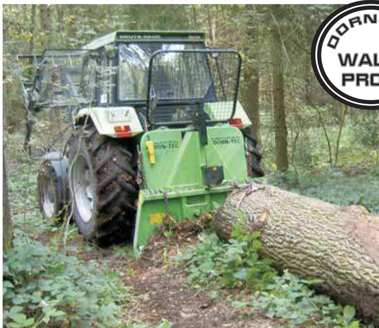
Treuil electrohydraulique 6500 EH avec radiocommande
