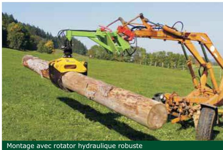
Montage avec rotator hydraulique robuste
