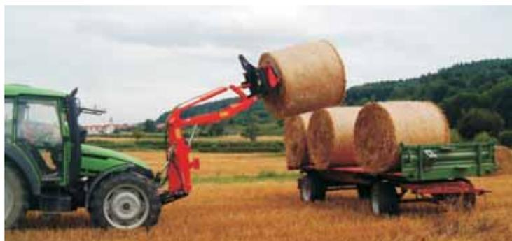
Chargeur arrière au chargement de balles
