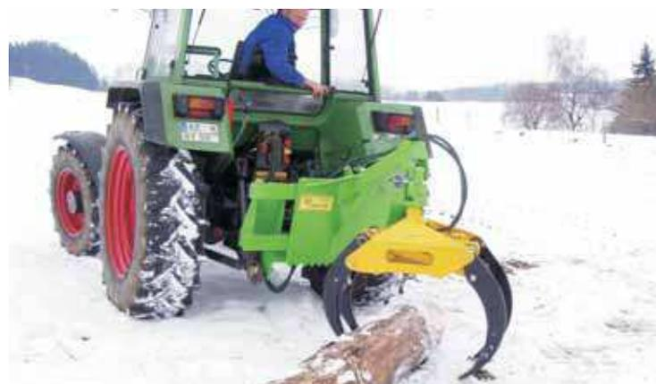
Travaux de débardage avec montage arrière
