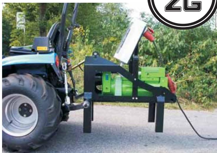
Chassis avec fixation 3-points pour le montage sur tracteur
