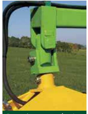
Raccord tournant mécanique
