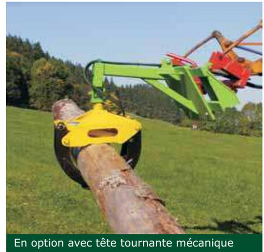
En option avec tête tournante mécanique
