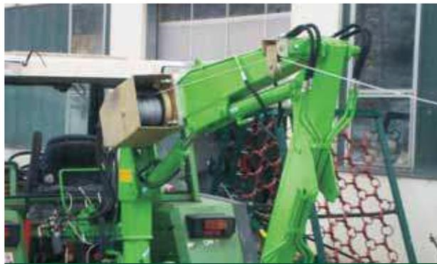
Enroulement propre du câble avec la poulie
