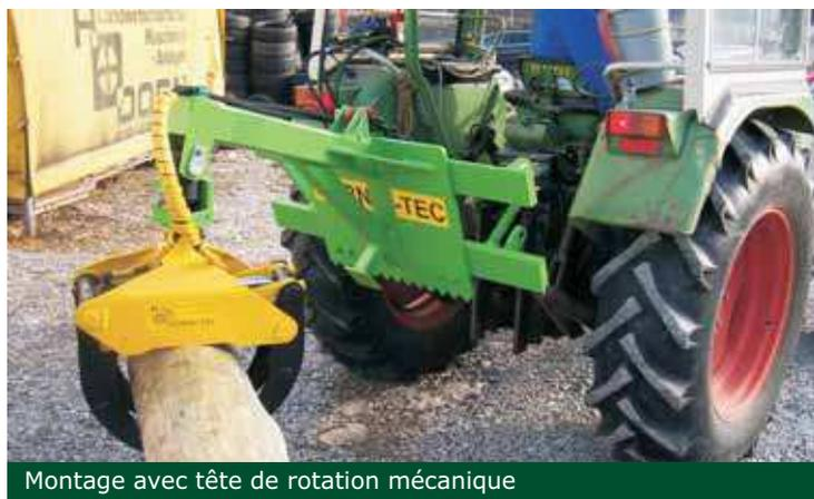
Montage avec tête de rotation mécanique
