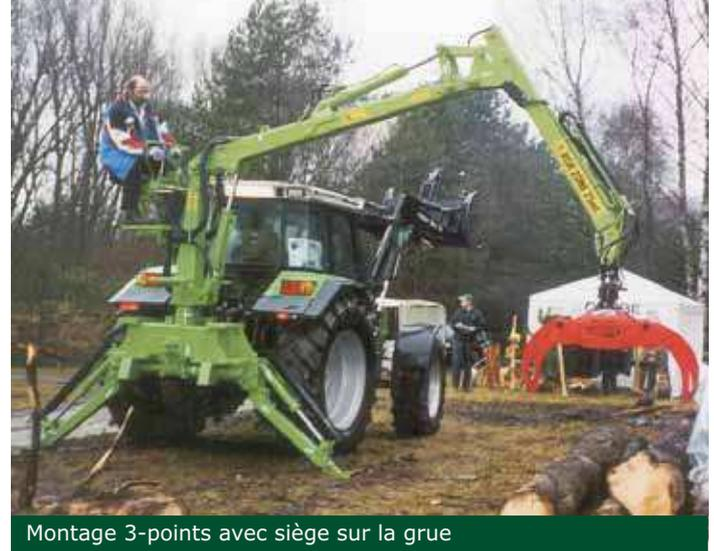
Montage 3-points avec siège sur la grue
