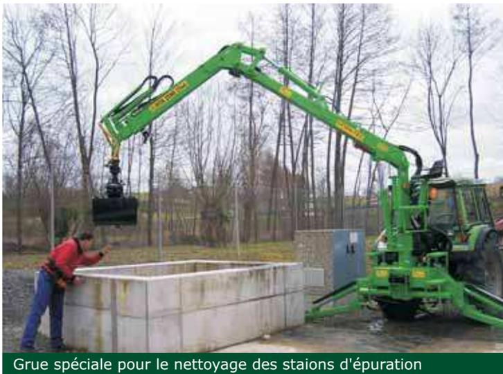
Grue spéciale pour le nettoyage des stations d'épuration
